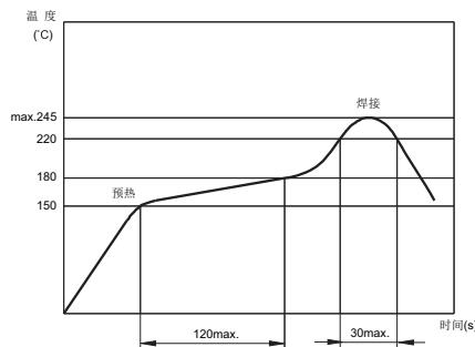
备注: (1) 图中所示温度曲线显示的温度是继电器放置处的PCB板的表面温度。
